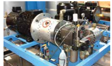
Bezobsługowa instalacja pompy dozującej polioli oraz izocyjanian w wysokociśnieniowych wtryskarkach PUR.
